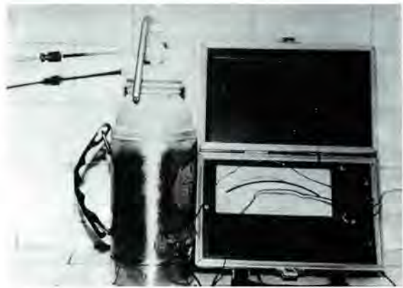
Fig. 1. Equipo de crioterapia con dispersor en botella para almacenar nitrógeno líquido y reloj de temperatura conectado a termocupla.
